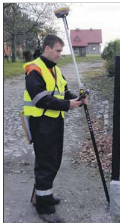
Pracownicy do pomiarów używają odbiornika GPS z akcelometrem, żyroskopem i magnetometrem
