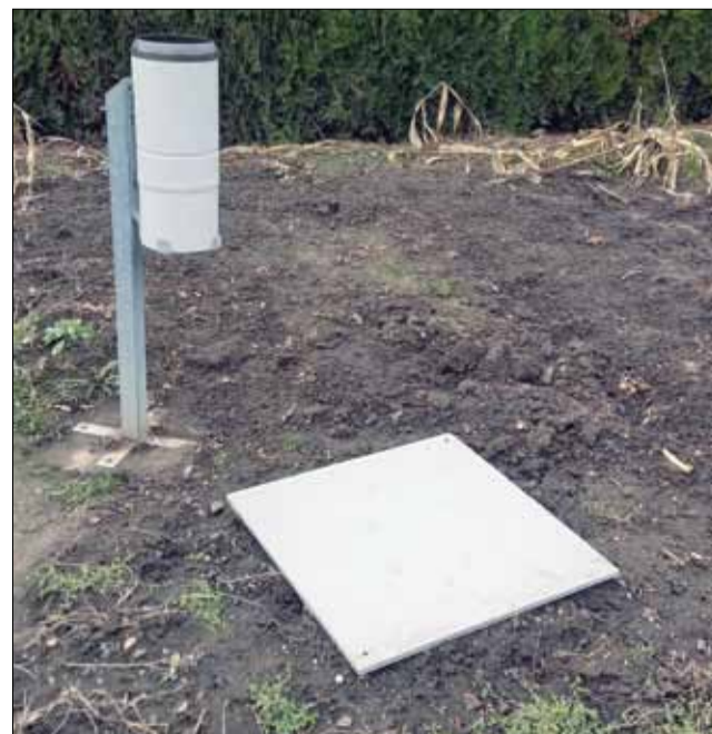
Wyposażenie posterunku opadowego to przede wszystkim deszczomierz. W ziemi używa się także specjalnej deski do pomiaru śniegu świeżo spadłego
